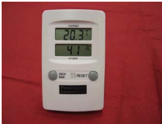
Aparelho para monitorar a temperatura e a umidade
